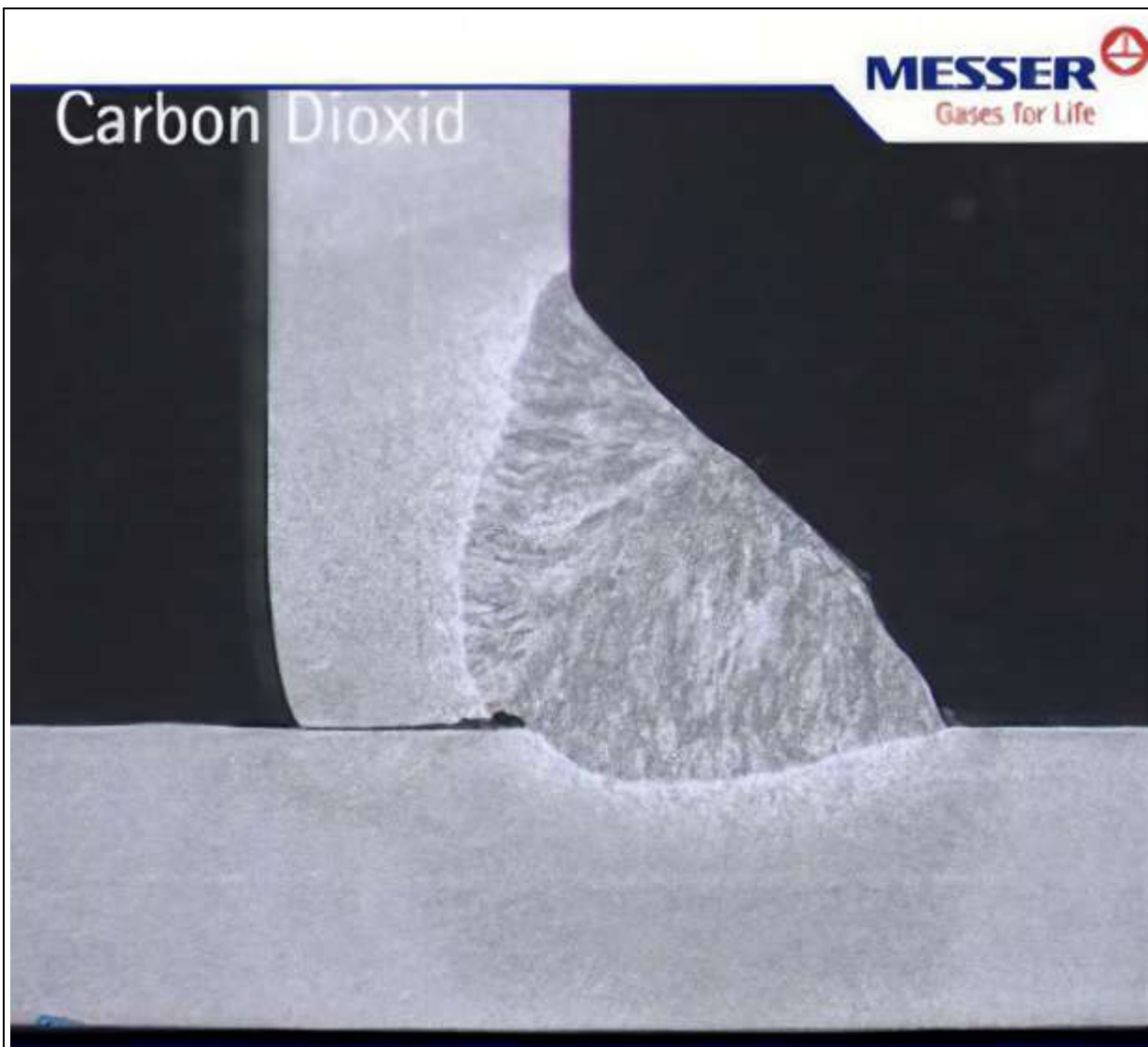
10.2. zīmējums. Ar CO 2 (100%) metinātas šuves profils [4]
