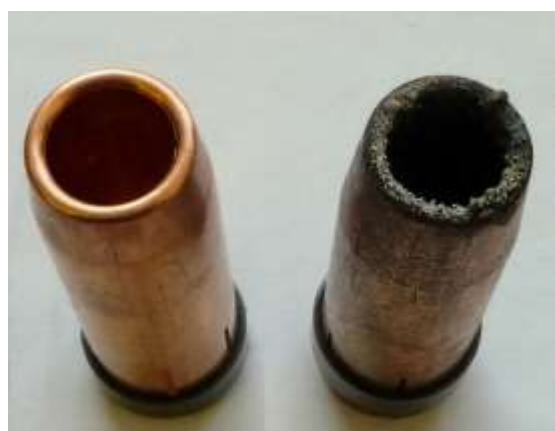
5.9. zīmējums. Sprausla attīrīta (pa kreisi) un neattīrīta (pa labi) [4].
