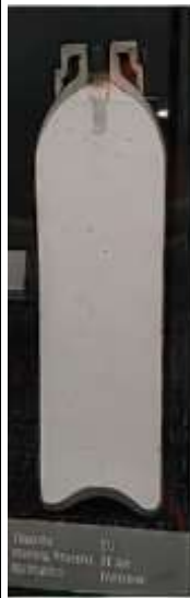
11.1. zīmējums. Acetilēna balons šķērsgrīzumā (balta viela ir poraina masa)
