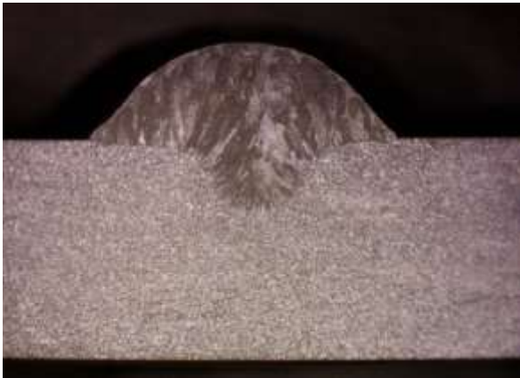
10.14. zīmējums Ar Inoxline He15C2 metinātas šuves profils. Parauga metināšana veikta kompānijas MESSER laboratorijā [4]
