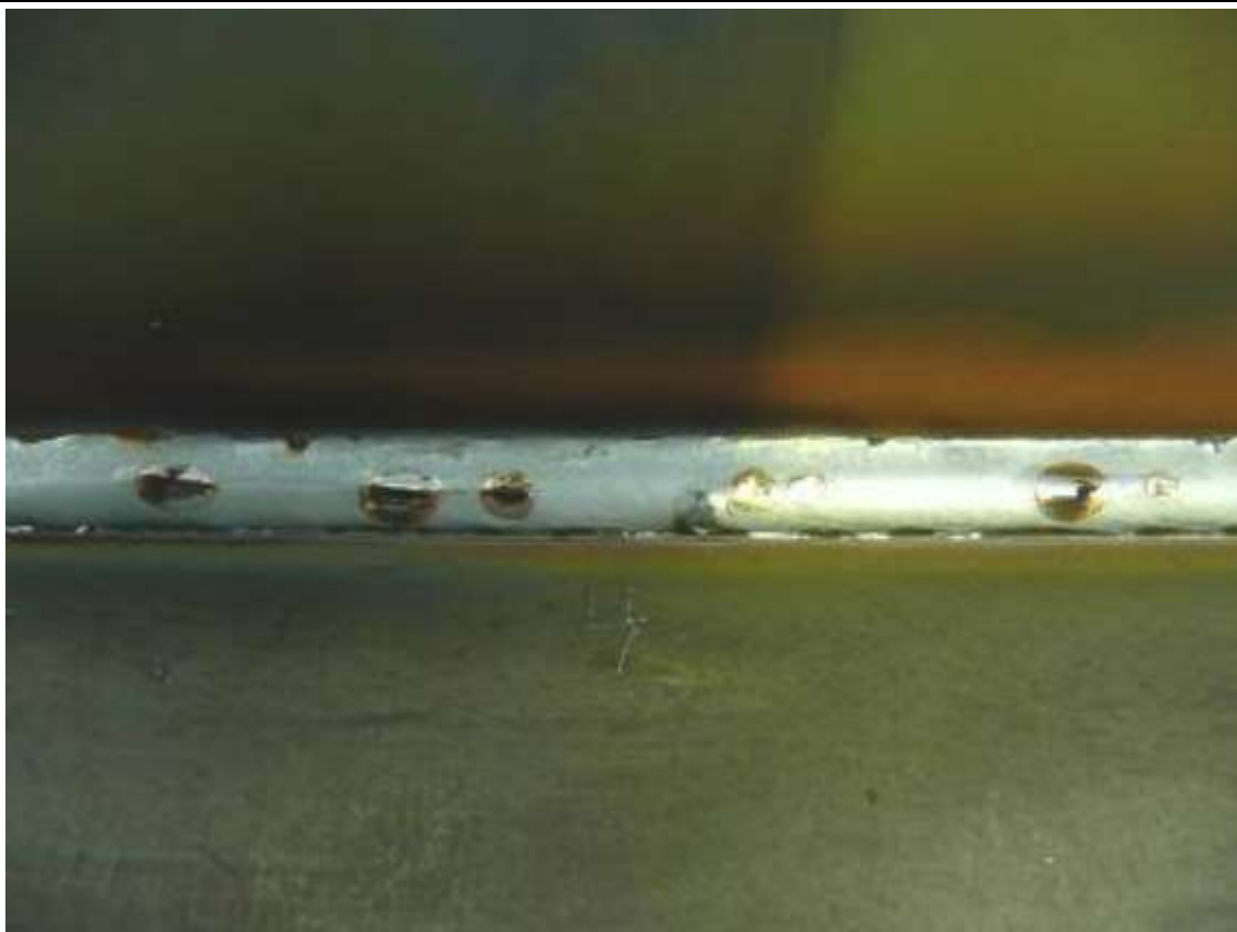
10.12. zīmējums Ar Ferroline C6X1 metinātas šuves ārējais izskats, strūklas pārnese režīms. Raksturīgs minimāls šlakatu un izdedžu daudzums.
