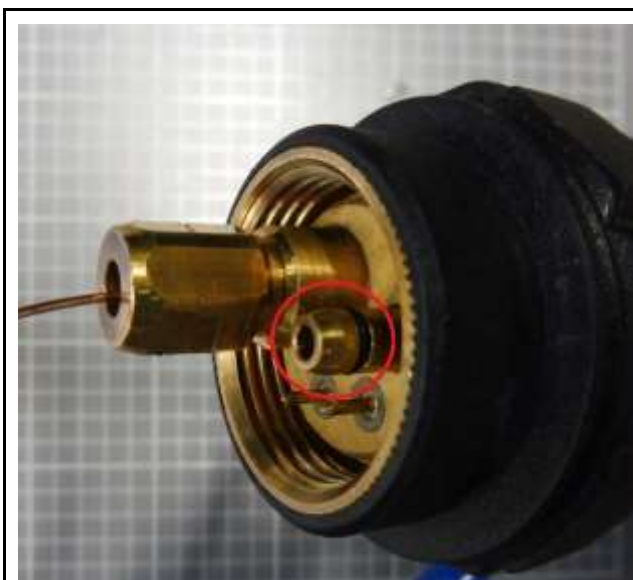
5.8. zīmējums. Metināšanas degļa Eiro-savienotājs [4].
