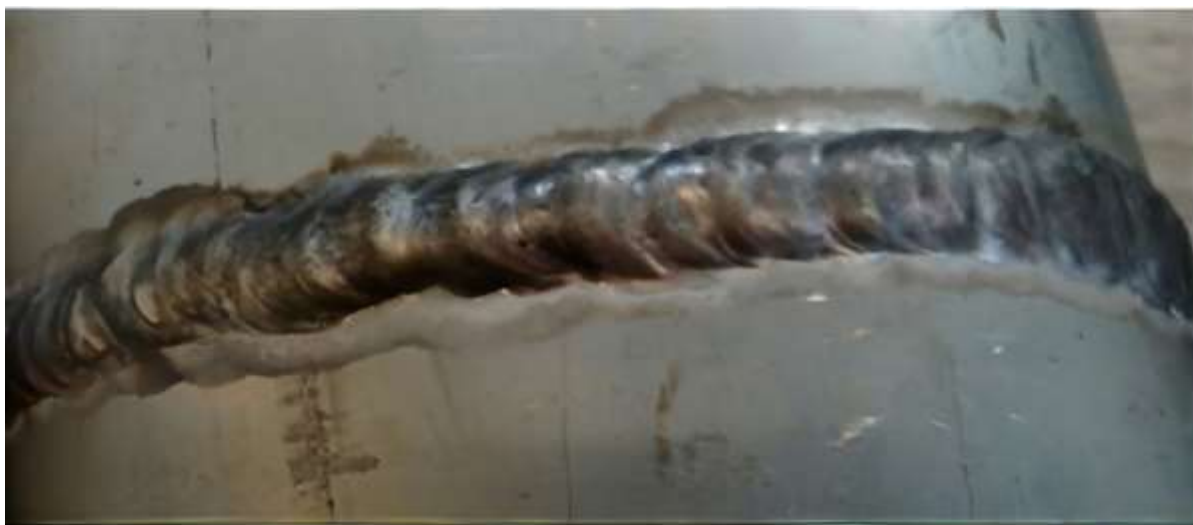
10.6. attēls. TIG metināšanas šuves izskats (alumīnija sakausējums) Caurule, metināta ar Argonu (Ar 4.8 – 99,998%)
