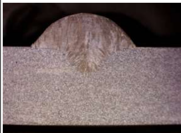
10.15. zīmējums Ar Inoxline C3H1 metināts šuves profils. Parauga metināšana veikta kompānijas MESSER laboratorijā [4]
