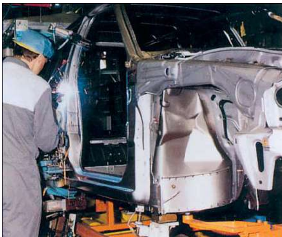
Сварка кузова автомашины методом MAGM
