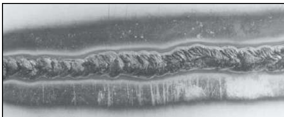
То же самое без использования защитного газа
