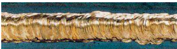
Шов, полученный при MSG пайке
